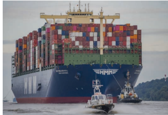
Le porte containers géant «Algerias» dans le port de Anvers. Ce navire mesure 400 mètres de long et 60 de mètres de large. Grâce à ses moteurs d'une puissance de 100'000 CV, il est capable de transporter 24'000 containers, ce qui représente une charge de 230'000 tonnes.
